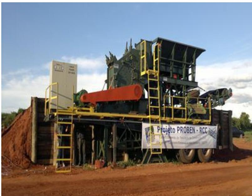
FIGURA 14: Equipamento de beneficiamento de resíduos da construção civil.
